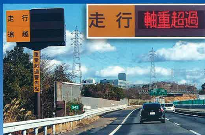
高速道路本線での「軸重超過」表示
